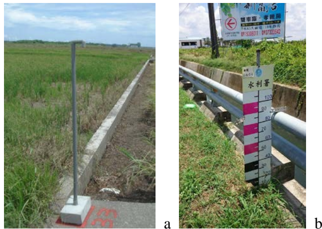
圖 9 淹水紀錄方式：a 水痕尺；b 淹水深度看板
