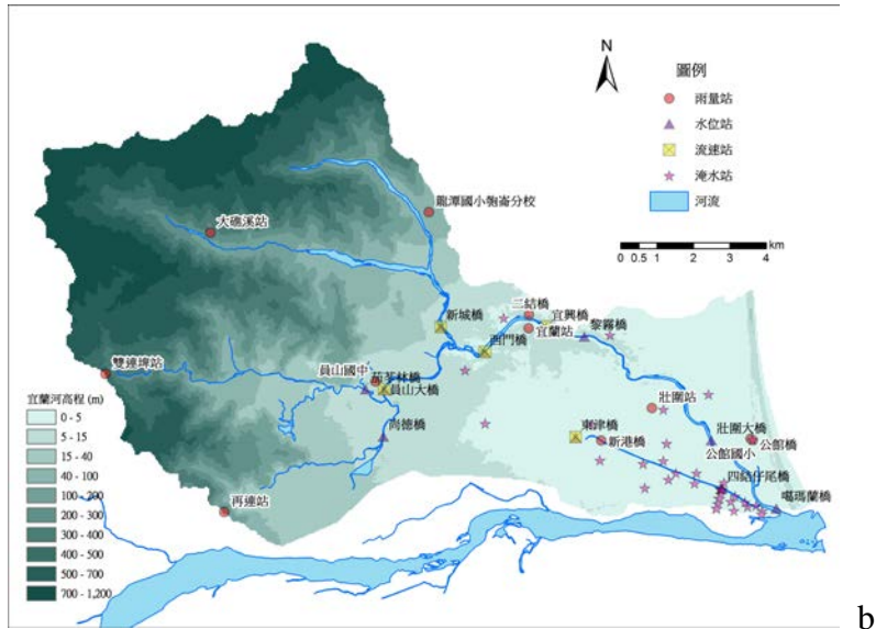
圖 3 宜蘭河試驗流域水文監測站分佈：a 建置前；b 建置後
