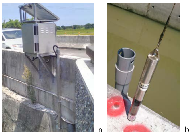
圖 10 淹水水位測站：a 具即時傳輸設備；b 自記式壓力式水位計
