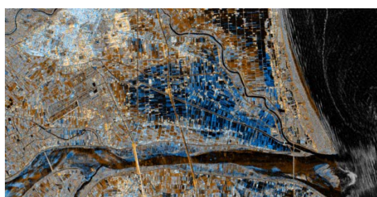
圖 4 蘇拉颱風期間美福排水集水區淹水況；藍色部分表示水體（影像來源：TerraSAR-X 雷達影像，2012/8/2 6pm）
