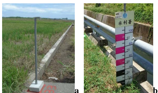
圖 9 淹水紀錄方式：a 水痕尺；b 淹水深度看板
