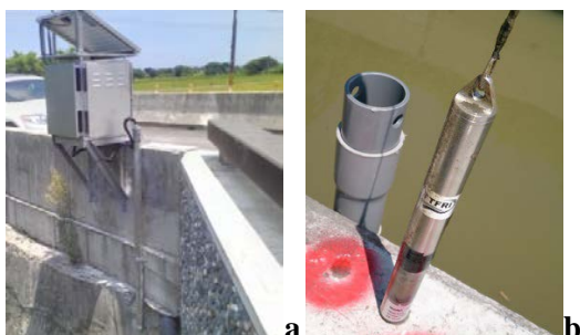
圖 10 淹水水位測站：a 具即時傳輸設備；b 自記式壓力式水位計
