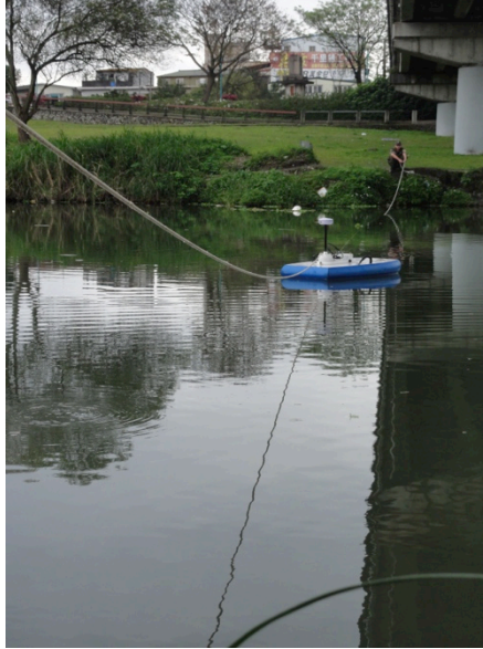
圖 6 聲波都卜勒流速剖面儀(RiverSurveyor M9)於宜蘭河中山橋操作情況
